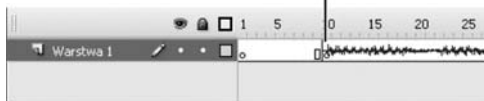
Rysunek 8.1. Umieszczenie dźwięku w klatce kluczowej na listwie czasowej to najprostszy sposób dołączenia dźwięku do filmu, niewymagający użycia ActionScript
